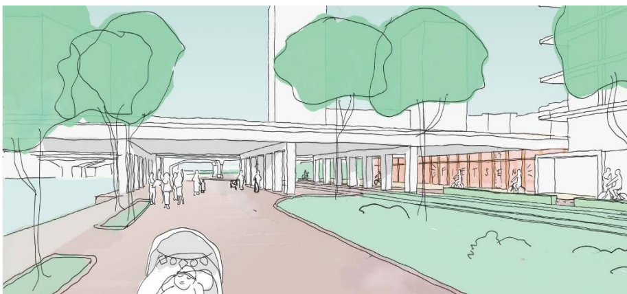
Figuur 27 Impressie vervangen constructieve wanden door kolommen
